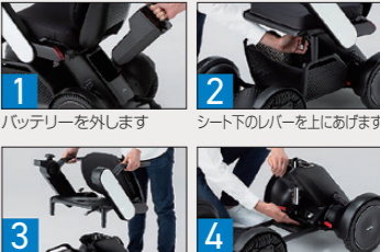
シートを上に引き抜きます メインボディ下のフックを持ち上げることで、2つに分かれます
