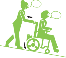
② 下り坂もゆっくり安心 下り坂では自動的にブレーキが かかります。 ここがポイント！ グリップを 引くと モーターが後方へ アシスト
