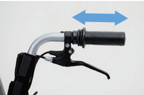
グリップブッシュ グリップの押し引きの力加減で走行速度 を調整できるため、手動車椅子と同じ 感覚で直感的な操作ができます。
