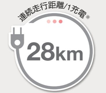
※連続走行距離は、常温(20℃)、使用者最大体重、満充電の新品バッテリーで平坦路を最高速度で連続走行した時、バッテリーが100%放電するまでの距離を示しています。
