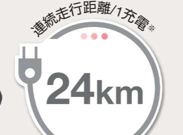
※連続走行距離は、常温(20℃)、使用者最大体重、満充電の新品バッテリーで平坦路を最高速度で連続走行した時、バッテリーが100%放電するまでの距離を示しています。
