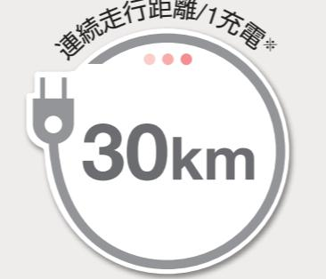
※連続走行距離は、常温(20℃)、使用者最大体重、満充電の新品バッテリーで平坦路を最高速度で連続走行した時、バッテリーが100%放電するまでの距離を示しています。
